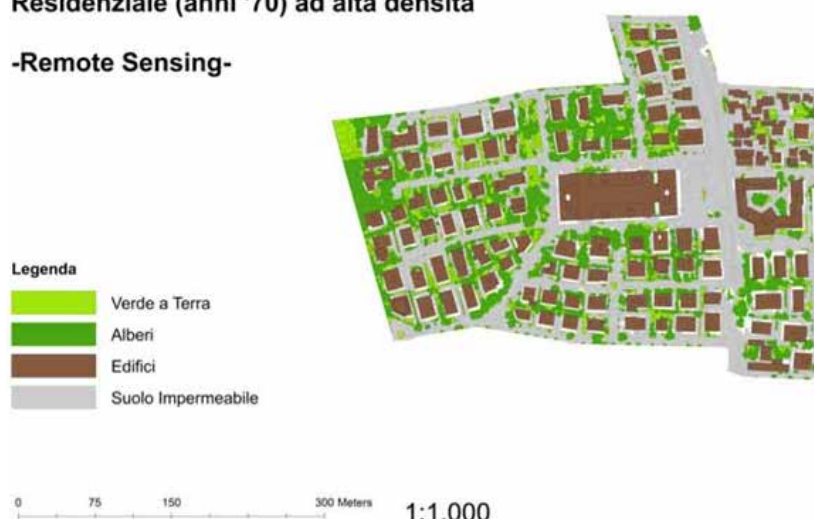
Fig.5. Analisi delle superfici orizzontali urbane. La tecnica utilizzata ha permesso la suddivisione delle superfici dell'area selezionata attraverso una procedura automatica. La possibilità di scomporre e misurare le tipologie di copertura della città con un dettaglio di 0,5 m2, ha permesso la creazione di un atlante delle superfici di grande dettaglio utile non solo agli studi concernenti l'isola di calore urbana, ma adatto anche a supportare le analisi riguardanti il rischio idrologico e valutare i servizi ecosistemici urbani.
