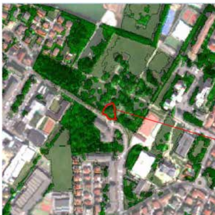
Fig.4 Il geo-database consente di contabilizzare ed interrogare la vegetazione con grande accuratezza. Nell'esempio in figura il gruppo di alberi selezionati hanno un'altezza di 12 m e un'estensione della chioma pari a 263 m 2 .
